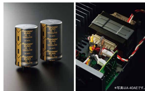
A-40AEに搭載されるカスタムコンデンサー トランスから各基板へ電源を供給する配線を立体的にスタッキングする事で干渉を排除
