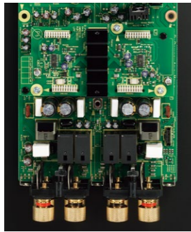
クラスDアンプ回路ブロック
