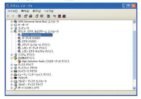
上記の表示がないときは、USB-B端子搭載製品の入力がUSB-B端子に対応する入力になっていることを確認してから、ケーブルを挿入し直すか、電源を一度オフにしてからオンにし直すと再認識されます。
