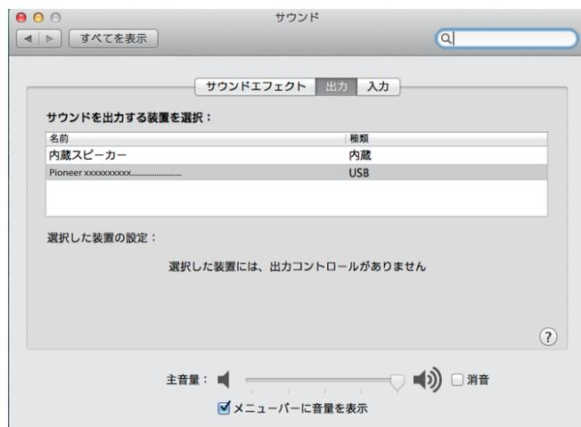
上記の表示がないときは、USB-B 端子搭載製品の入力が USB-B 端子に対応する入力になっていることを確認してから、ケーブルを挿入し直すか、電源を一度オフにしてからオンにし直すと再認識されます。
